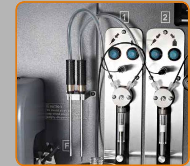
图1 自动分液器，实现快速而精准的同时分液检测
